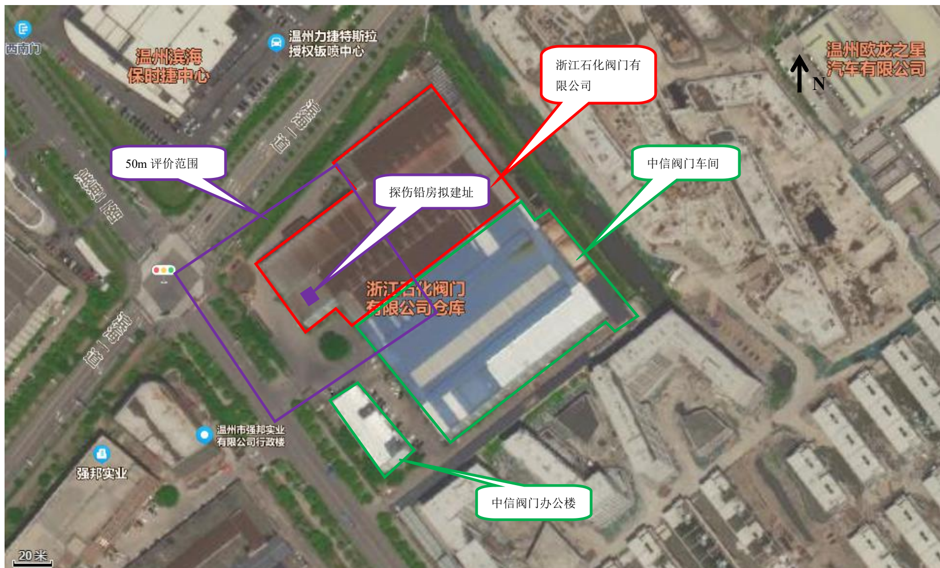
附图 2 建设单位周围环境、探伤铅房拟建址及 50m 评价范围概况图
