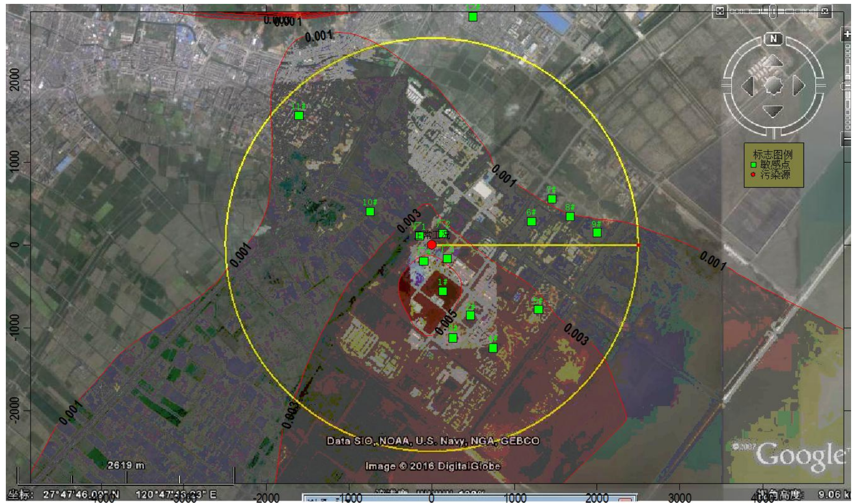
图 6.1-19 正常工况下 Pb 最大地面年均浓度等值线分布图 (单位: \mu\text{g}/\text{m}^3 )
