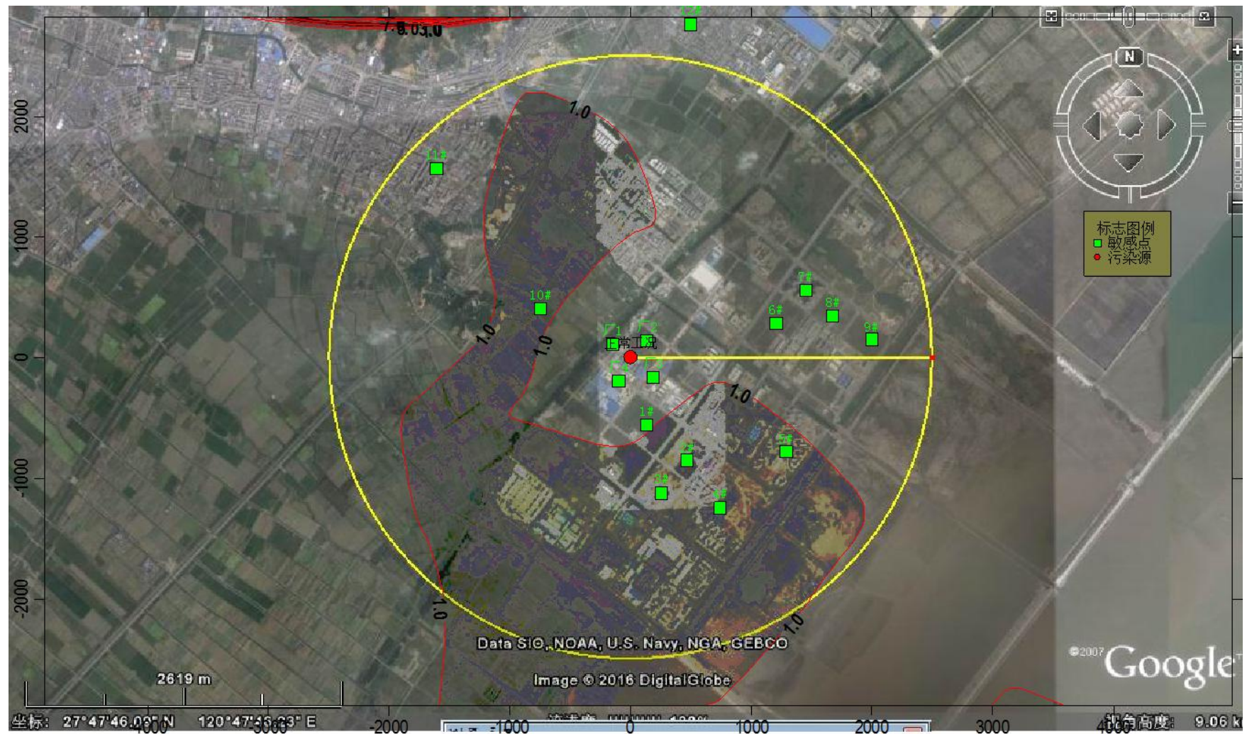
图 6.1-8 正常工况下 HCl 最大地面小时浓度等值线分布图 (单位: \mu\text{g}/\text{m}^3 )
