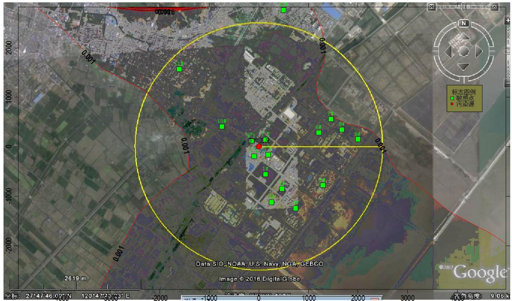
图 6.1-15 正常工况下 Cd 最大地面日均浓度等值线分布图 (单位: \mu\text{g}/\text{m}^3 )
