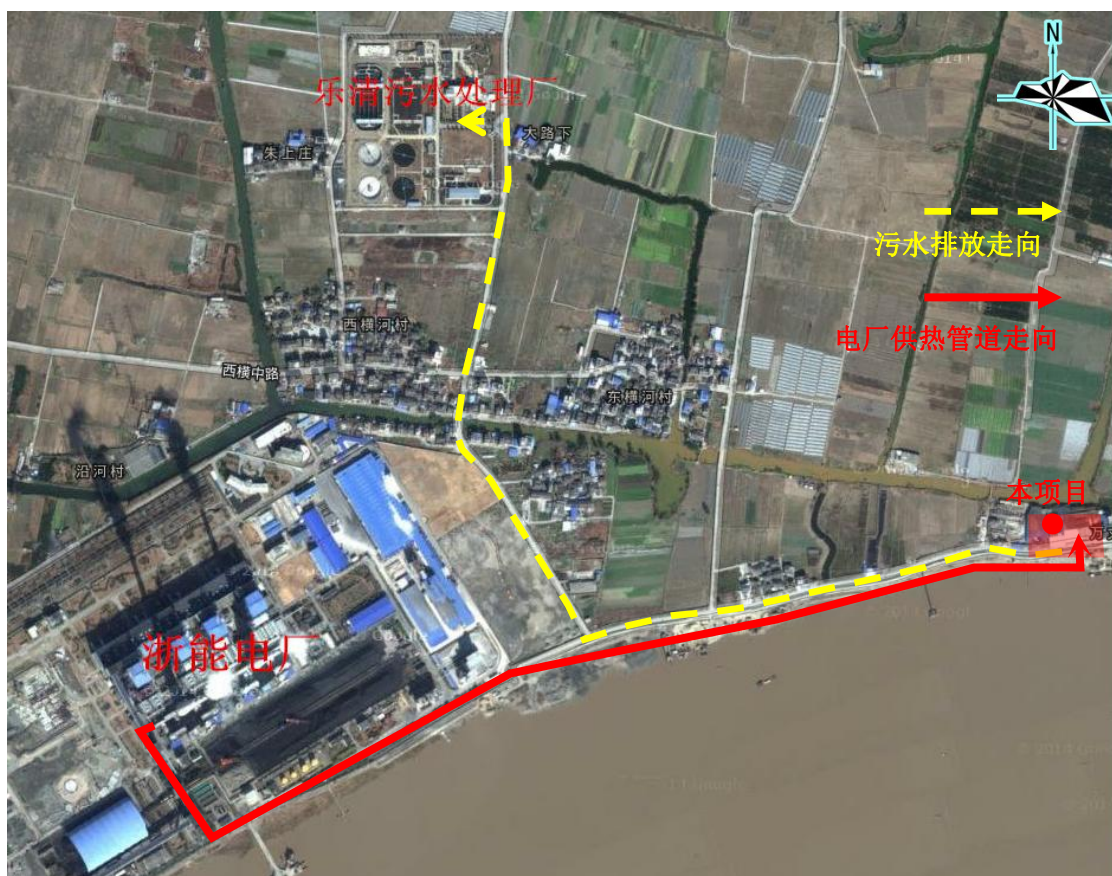
图 4.4-1 本项目排水供热管道走向示意图
