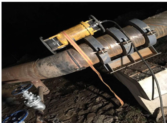
图 6-6 现场探伤装置及工件
