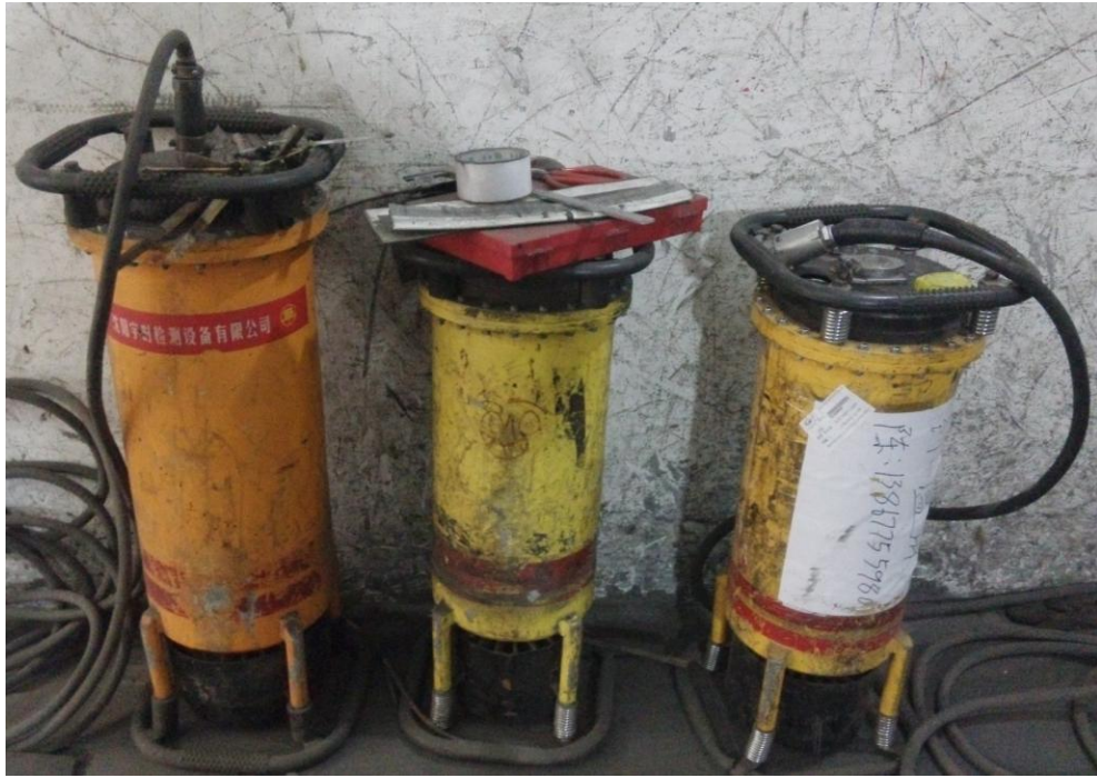
图 6-1 工业 X 射线探伤机
