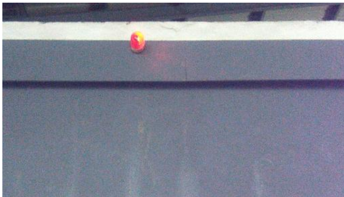
图 6-2 工件入口防护门上方工作警示灯
