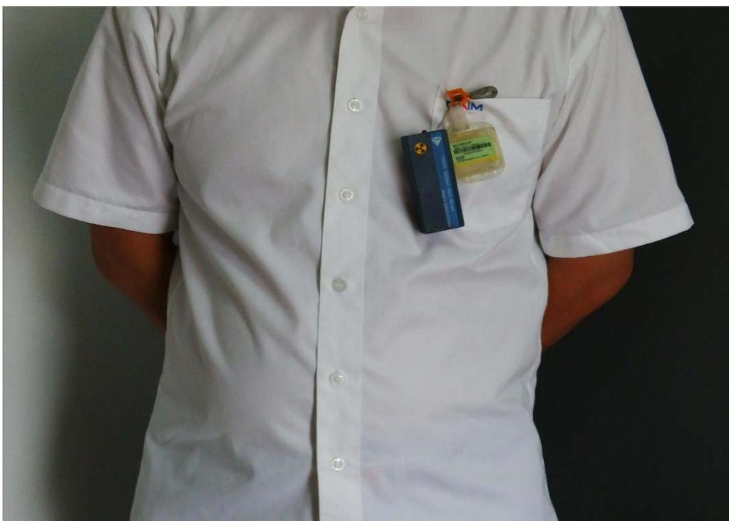
图 6-10 辐射工作人员佩戴个人剂量计和报警仪
