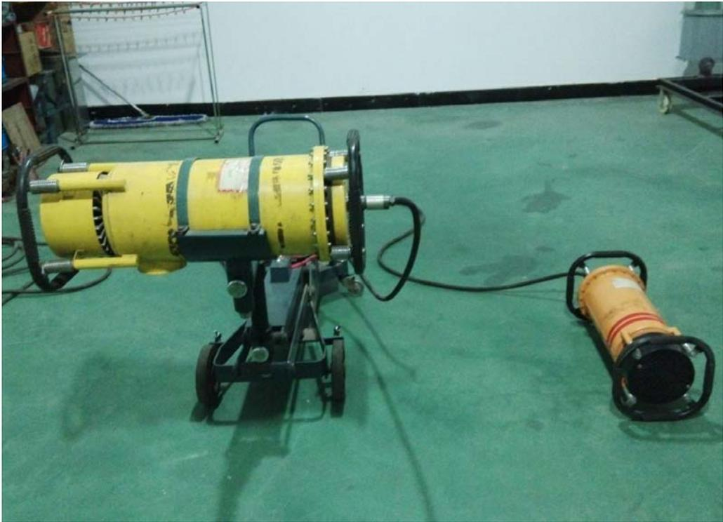
图 6-1 工业 X 射线探伤机
